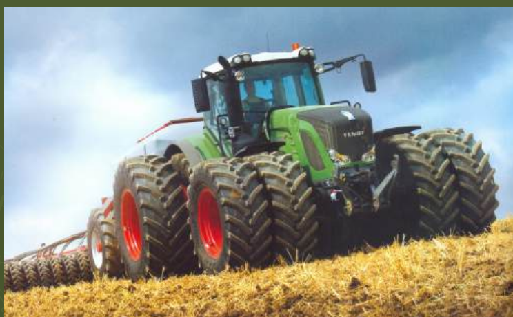
Трактор точкаш Fendt 939 снаге 390 KS
