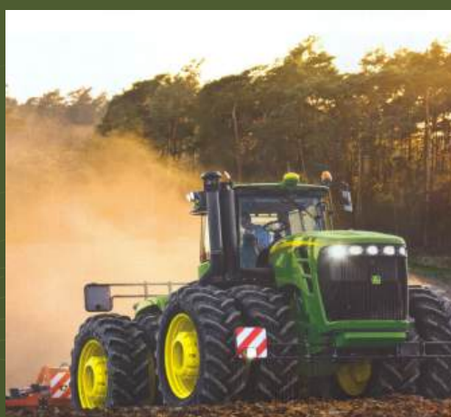
Зглобни трактор John Deere серије 9030, снаге 563 KS
