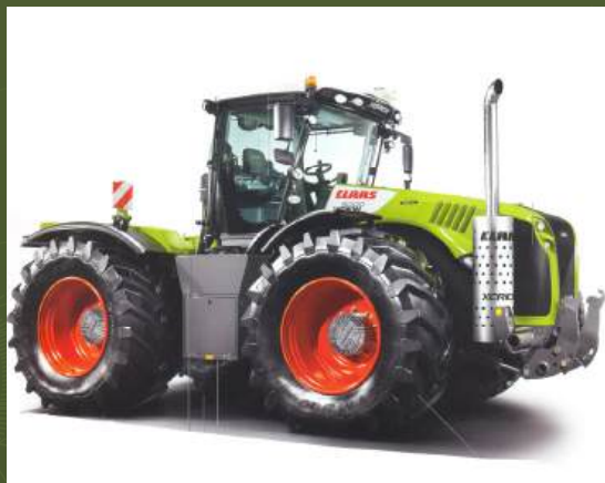
Компактни трактор Herion 5000 снаге 524 KS
