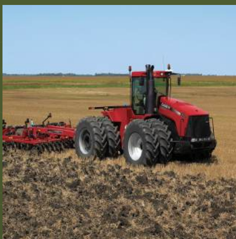
Зглобни трактор CASE снаге 534 KS
