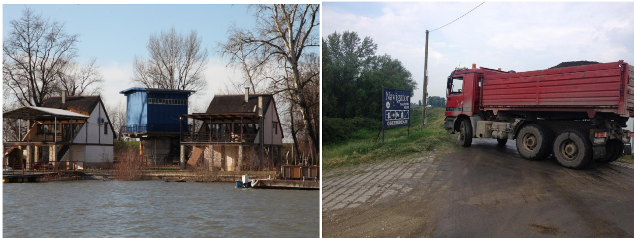
Слика 4. Злоупотреба водног земљишта и насипа; лево: бунар београдског водовода опкољен илегалним кућама; десно: разарање савског насипа који није димензионисан за саобраћај тешких и других возила, осим сервисних возила
